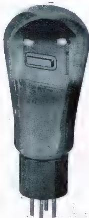
Bild 1. Das Kästchen auf der Anode ist ein Zeichen dafür, daß es sich um eine Röhre mit Bariumdampfkathode handelt.
