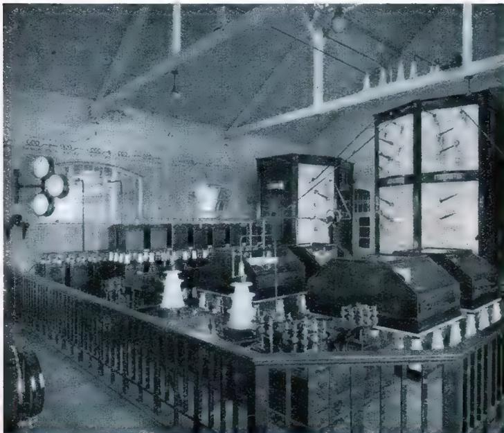
Mit der Einführung des Löschkunkens gewann Telefunken einen gewaltigen Vorsprung in der Funktechnik. Das Bild zeigt den damaligen Löschkunksender (1916). — Oberes Bild: Die an der Heilandskirche in Sakrow bei Potsdam zur Erinnerung an die Errichtung der ersten deutschen Antennenanlage angebrachte Plakette. (Archivbilder)
